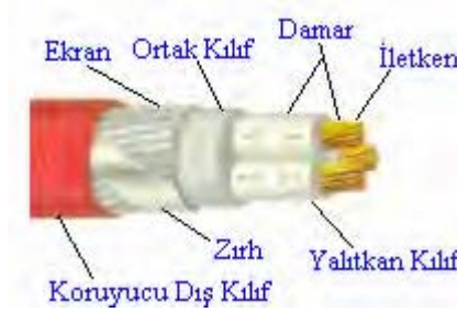
Şekil 2.1 YVŞV(NYFGbY) Kablolsunun iç yapısı (siemens)
